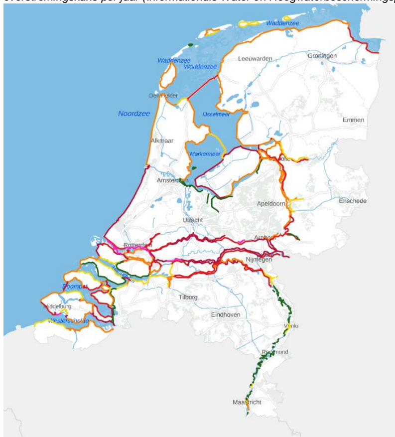
Figuur 1: Overzichtskaart van de primaire keringen van Nederland met de bijbehorende normering uitgedrukt in overstromingskans per jaar (Informatiehuis Water en Hoogwaterbeschermingsprogramma, 2019)
